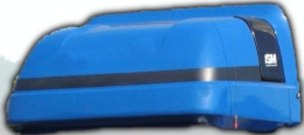
Die Fa. Grünhage International bietet den neuen aerodynamischen TOPSLEEPER aus GFK-Material zur Nachrüstung an. Dieser Topsleeper ist ein Produkt der Extraklasse und entspricht der ISO Norm 9002 in Bezug auf Produkt und Qualität. Das Produkt kann ohne viel Aufwand an einem Tag auf das vorhandene Fahrerhaus montiert werden. Die Lieferzeit beträgt ca. 1 Monat ab Bestelltag. Die Nachrüstung eignet sich speziell für kleine und mittlere Lastkraftwagen folgender Marken:
