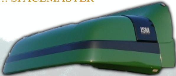
Die Fa. Grünhage International bietet den neuen aerodynamischen Spacemaster aus GFK-Material zur Nachrüstung an. Dieser Topsleeper ist ein Produkt der Extraklasse und entspricht der ISO Norm 9002 in Bezug auf Produkt und Qualität. Das Produkt kann ohne viel Aufwand an einem Tag auf das vorhandene Fahrerhaus montiert werden. Die Lieferzeit beträgt ca. 1 Monat ab Bestelldatum. Die Nachrüstung eignet sich speziell für kleine und mittlere Lastkraftwagen folgender Marken:
